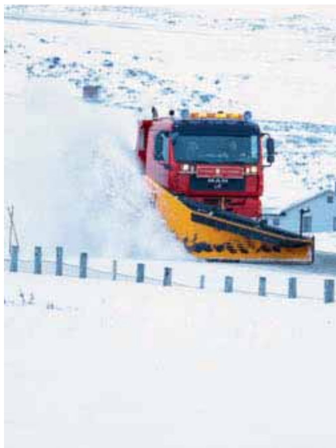
BRØYTING Reservebilen er denne MAN TGA 26.480 med tandemdrift. Diagonalskjæret er til godværsbruk.
