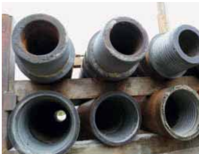
Tungt Disse stålrørene har en diameter på 10 tommer, er 1,5 meter lange og veier hele 300 kg.
