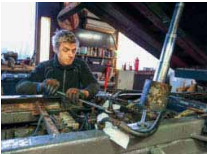
MEKANIKER Aleksander Eidissen (23) demonterer tipsynliden på brøytebilen.
