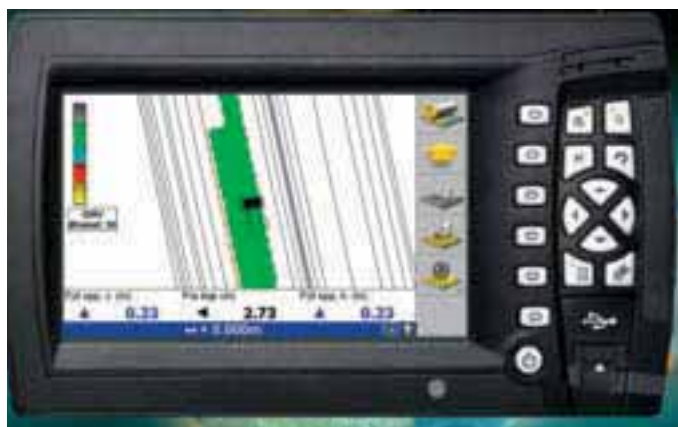
KONTROLL Trimble CCS 900 kontrolleres fra denne boksen. (Foto: Sitech AS)
