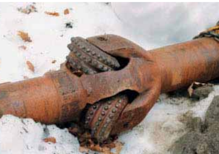
Opprømmerkrone Dette er en typisk opprømmerkrone, som festes på enden av en borestreng og utvider hullet når strengen trekkes tilbake.
