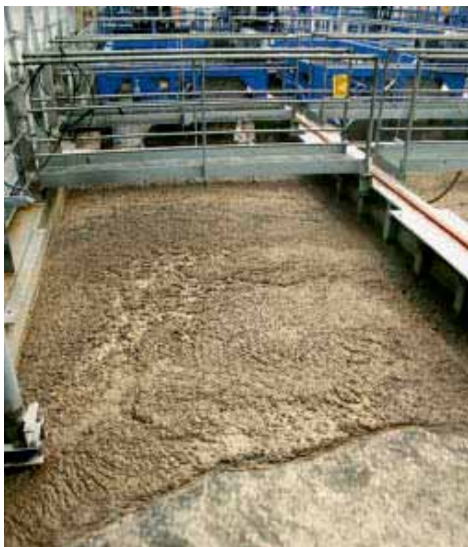
De skitne partiklene skilles raskt ut fra snøen i smelteanlegget.
