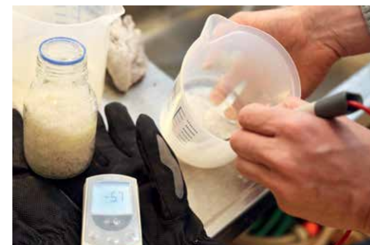
PÅ FRYSEPUNKTET: Klein-Paste illustrerer hvordan salt (natriumklorid) som tilsettes vann gjør at blandingen får et lavere frysepunkt enn rent vann. Her har den flytende løsningen -5,7 grader. Frysepunktet blir imidlertid aldri lavere enn minus 21 grader C.
