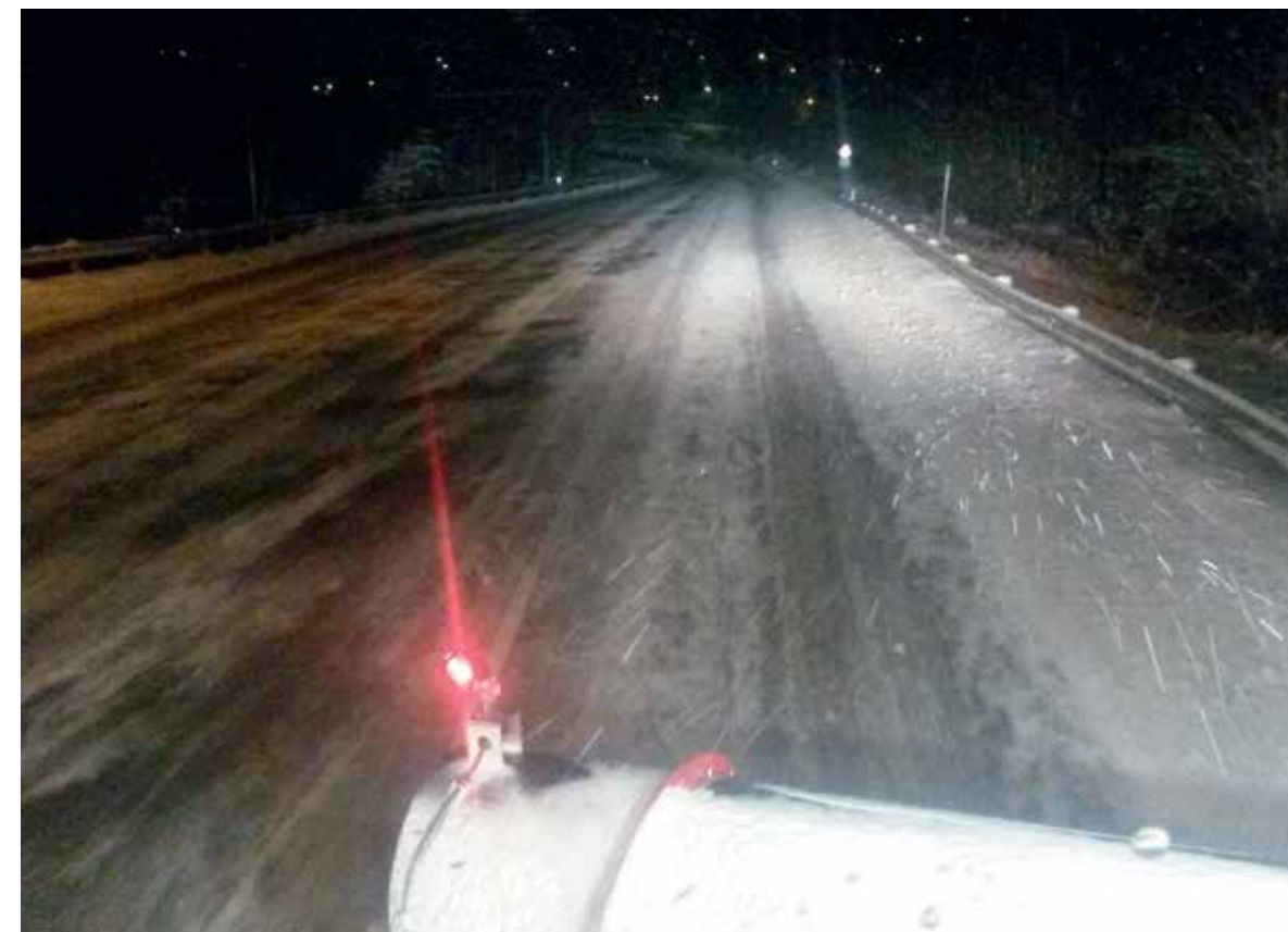
FORSKJELL: På venstre side av veien er det brukt 10 gram vakuumsalt i 10 min, mens på høyre side, som ser urørt ut, er det brukt 20 gram sjøsalt i ca. 1 time. (FOTO: KNUT YSSEN)
