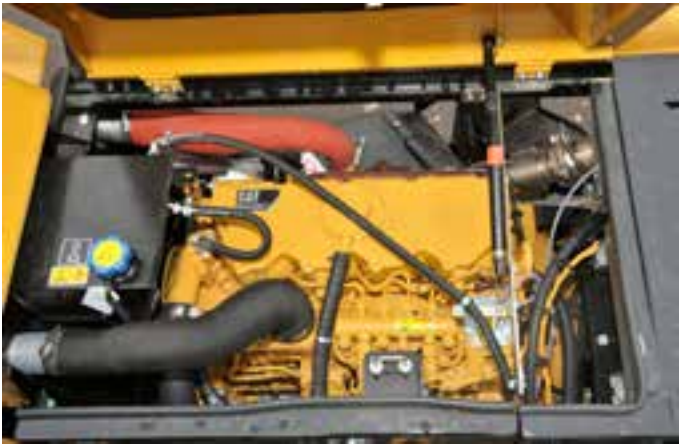
MOTOR: Caterpillars C4.4 med Acert motorstyring gir godt med kraft i både graving og kjøring.
