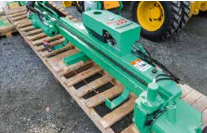
MIKRO-BORETÅRN: Montaberts minste boreapplikasjon til gravere. Micro heter den, men er ikke akkurat mikroskopisk.
