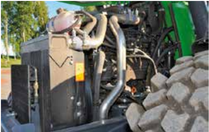
MOTOR: 4-sylindret steg IIIB-motor fra Sisu. Det virker smått på en 13-tonner, men holder i massevis.
